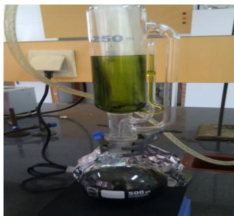
شکل ۱. فرآیند روغن‌گیری با استفاده از دستگاه سوکسله
